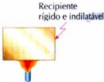
Figura 9. Transformação isocórica ( $\Delta V = 0$ )
