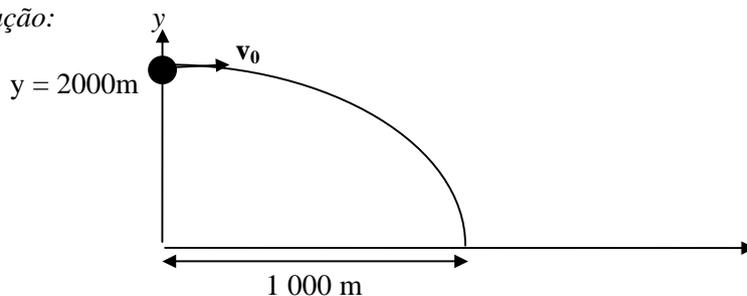
Como o avião está voando horizontalmente a velocidade da bomba é igual à do próprio avião. Chegaremos a esta velocidade pela eq:  $x_{\text{máx}} = v_0 \cdot t$ , onde t será o tempo de queda da bomba que deveremos calcular agora.
